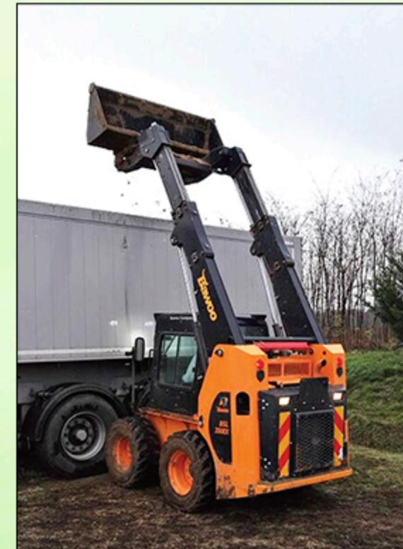
Две колесные модели и одна гусеничная машина BAWOO оснащены уникальными запатентованными **теле<sup>с</sup>ко<sup>п</sup>и<sup>ч</sup>ес<sup>к</sup>и<sup>м</sup>и** стрелами, **не имеющими аналогов** на рынке и позволяющими осуществлять выгрузку на высоте около 4 метров! Такие машины способны загрузить **любой борт**.
