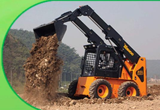
В «радиальных» машинах применяется одношарнирное крепление на стреле, и рабочее оборудование совершает движение только по радиусу. Тогда как в «вертикальных» машинах присутствует еще выдвижение стрелы вверх. Машины с радиальным подъемом в основном работают с навесным оборудованием, которое крепится ниже взгляда оператора (отвалы, щетки, некоторые виды ковшей), а вертикальный подъем позволяет комфортно работать с оборудованием, которое крепится выше взгляда оператора.
