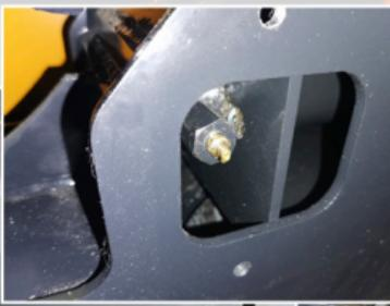
Все ролики надежно герметизированы, с металлическими торцевыми уплотнениями, предотвращающими попадание грязи для большей долговечности.
