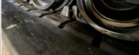
Гусеничная тележка улучшенной конструкции препятствует скоплению на ней грунта, упрощая очистку и сервисное обслуживание.
